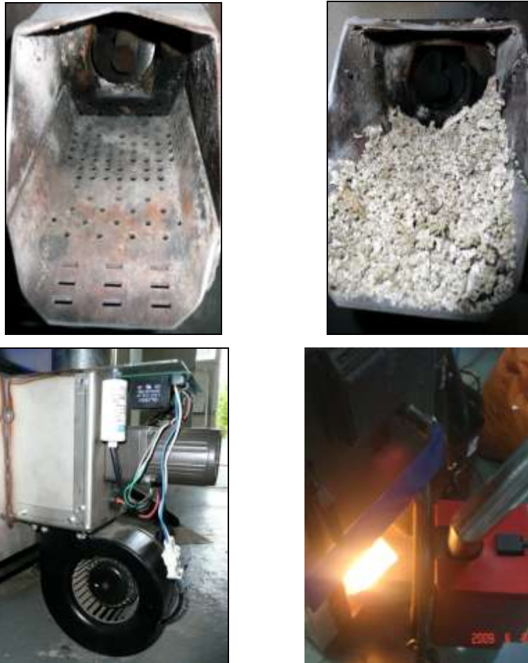
Rys. 2. Widok palnika: podajnik śrubowy i otwory wlotowe powietrza; popiół z łusek słonecznika; wentylator i podajnik palnika; płomień w palniku (otwartym dla demonstracji)
