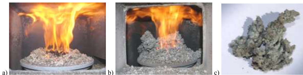
Rys. 3. Widok paleniska retortowego podczas spalania peletów pszenicznych (a), peletów miskantusa (b) oraz widok spieków tworzących się podczas spalania miskantusa (c)
