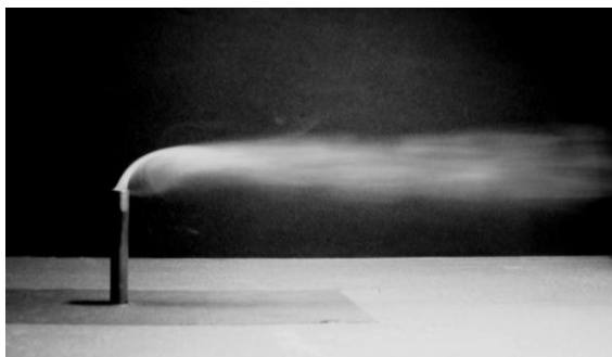
Rys.3 Niezakłócona smuga dymu z kominu wolnostojącego ; u_h = 1,0 m/s
