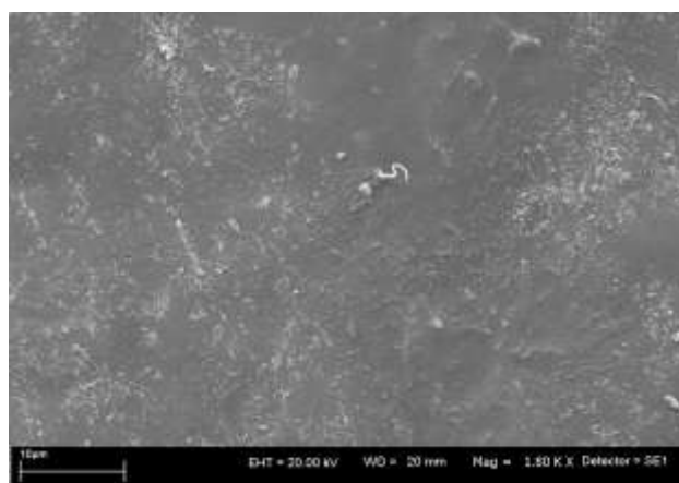
Rys.4. Zdjęcie z SEM próbki polipropylenu po usunięciu z jego powierzchni biofilmu metodą ultradźwięków
